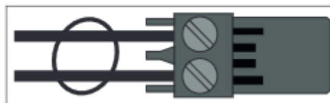
Afb. 34 Kabelbinder op connector
