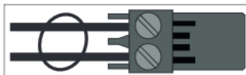
Afb. 34 Kabelbinder op connector
